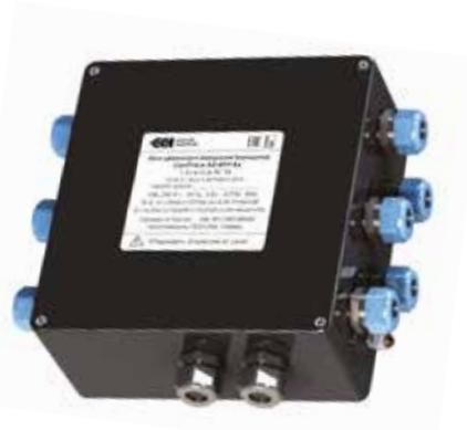
ConTrace AS-xxx-Ex в зависимости от типа исполнения может быть подключено до 8 термометров сопротивления. Поступающие с них данные передаются в шкаф управления посредством всего одного кабеля по стандарту RS-485. При этом на расстоянии в 1200 м может быть последовательно подключено до 16 блоков ConTrace AS-xxx-Ex. Это дает возможность отслеживать изменения температурных показателей системы электрообогрева в 128 точках одновременно.
